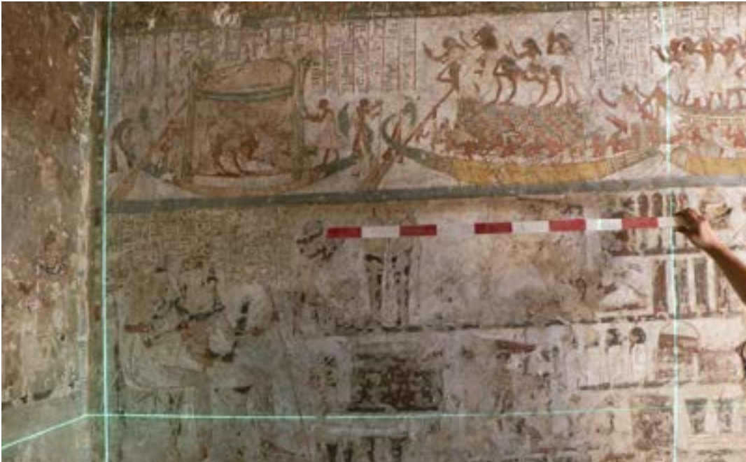
Figura 3: Utilização do nível de laser e de escala manual para tomar as medidas da cena da procissão funerária, no vestibulo da Tumba de Neferhotep (TT49).
